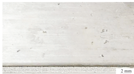
图7 工艺优化的汽车电池托盘用6061-T6铝合金挤压型材流道内部腐蚀测试后的宏观形貌
